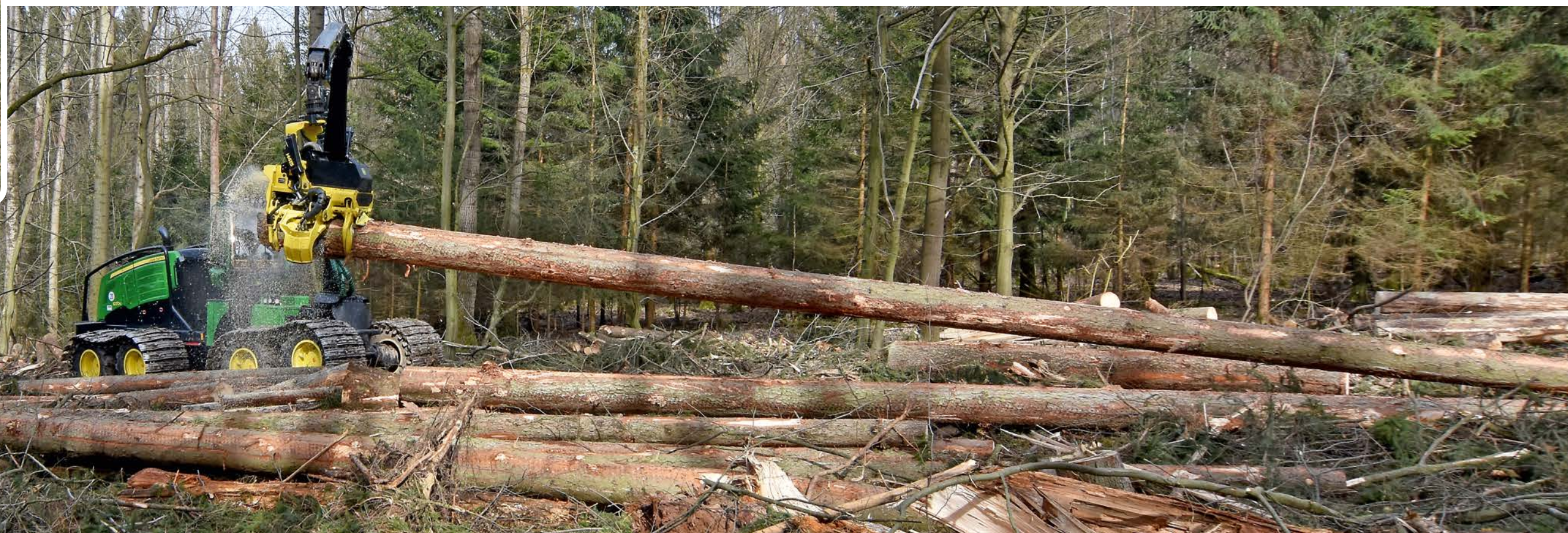
... während es mit vertikalem Sägekasten bis zu 75 Zentimeter starke Bäume packen und sägen kann. Grafiken: John Deere
